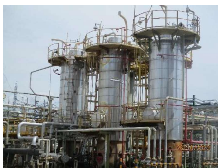
ภาพที่ 2-13 หน่วย Dehydrator (ใช้ร่วมกันกับ PP1)
