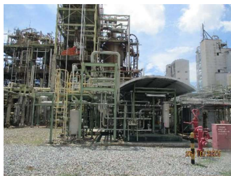
ภาพที่ 2-5 หน่วยงานกลับไอสารไฮโดรคาร์บอน (VOC Recovery Unit: VRU) ของโรงงานที่ 2
